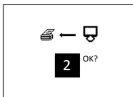
En la interfaz de impresión, pulse “◀” y “▶” para configurar la cantidad de resultados de análisis que desea imprimir. Presione el botón “OK” para confirmar la impresión.
